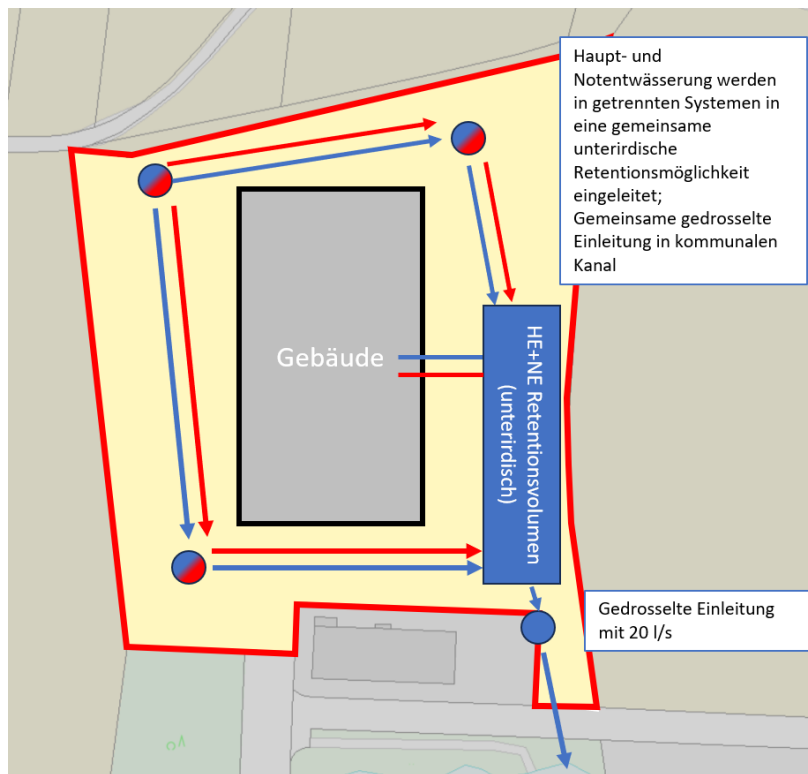
Abbildung 3: Gestaltung des Entwässerungssystems Variante 3
