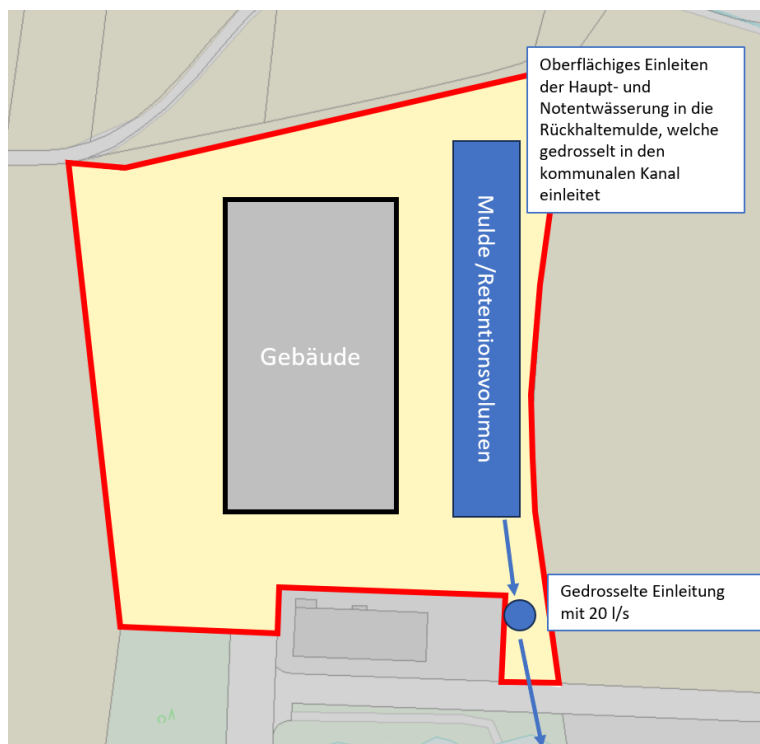
Abbildung 2: Gestaltung des Entwässerungssystems Variante 2
