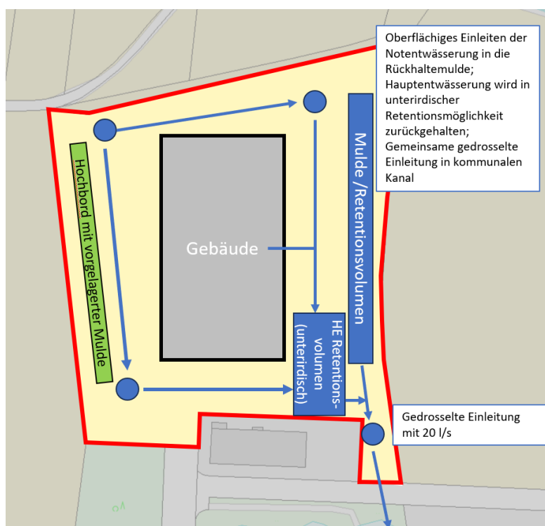
Abbildung 1: Gestaltung des Entwässerungssystems Variante 1
